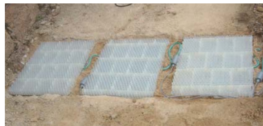
Dalles acoustiques préparées avec le revêtement nid d'abeille.
